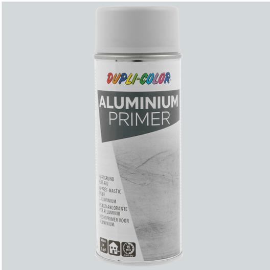
Spezialgrundierung für Aluminiumflächen auf spezieller Acrylharz-Basis. Hervorragender Haftvermittler zwischen Aluminiumuntergrund und nachfolgendem Decklack. Bedingt auch für Zink und Kupfer geeignet, wenn eine anschließende Lackierung gewünscht wird. Kann mit allen lufttrocknenden Acryl-, NC- und Kunstharzlacken überlackiert werden, z.B. mit DUPLI-COLOR Auto-Spray oder DUPLI-COLOR ALL SEASON.
